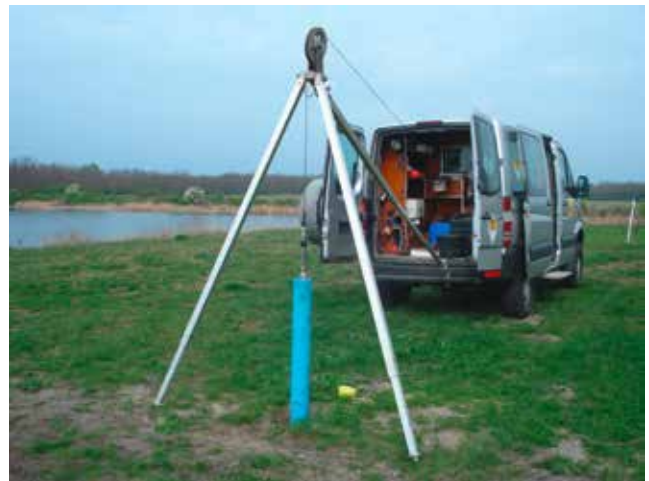
Abb. 3: Messfahrzeug mit in eine Grundwassermessstelle einfahrendem Induktions-Log
