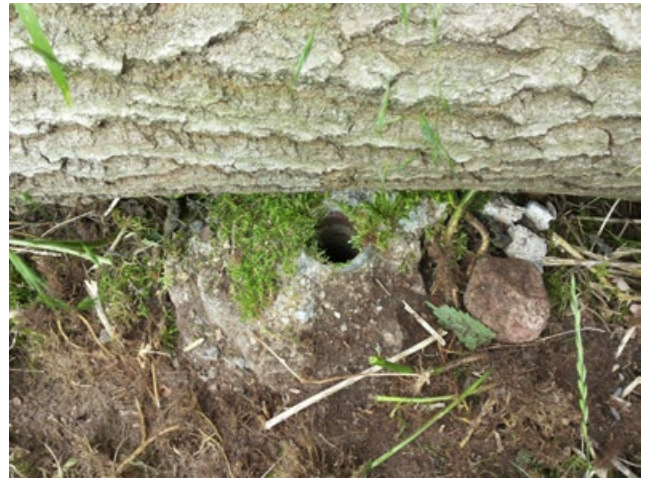
Abb. 2 – Exemplarische Fotodokumentation von zwei beschädigten und nicht mehr funktionstüchtigen Grundwassermessstellen
