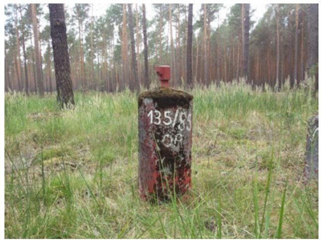
Abb. 2 – Exemplarische Fotodokumentation von zwei beschädigten und nicht mehr funktionstüchtigen Grundwassermessstellen
