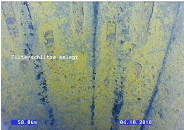
Abb. 4 – Exemplarische Darstellung von Ergebnissen der Fernsehsondierungen an zwei alten Grundwassermessstellen
