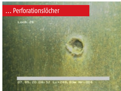
Abb. 6 – Nachweis der Perforationslöcher und des unbeschädigten Kupferrohres
