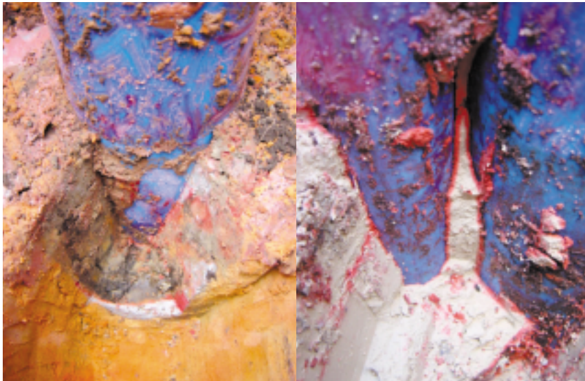
Bild 7: Stark inhomogenes Material (links), Wegsamkeit an der Grenzfläche zur Ausbauperforation (rechts). Quelle: RUBBERT (2002)
