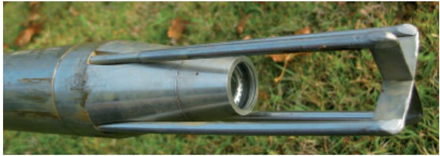
**Abb. 5** Bohrlochmesssonde zum optischen Nachweis der Tracer Uranin und Eosin
