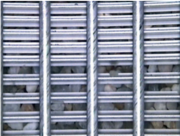
Abb. 10 – Wechsel der Schlitzweite innerhalb eines Edelstahl-Wickeldrahtfilterrohres (Horizontalblick)
