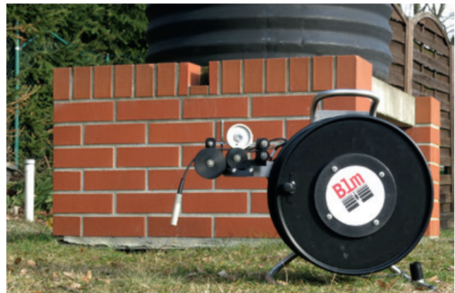
Abb. 1 – Von der SENSYS GmbH neu entwickelte Messsonde mit Kabeltrommel und Teufenzählwerk
